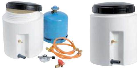
In accordo con la ISO 10239, norma che prevede che le bombole del gas messe all'interno della barca siano contenute in un vano isolato e ventilato collegato con l'esterno. Fabbricato in **polietilene**. Accetta bombole tipo camping gas o simili, va completato con il kit 50.013.92.
