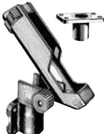
In nylon. Può ruotare ed essere bloccato per 360° in senso orizzontale e per 140° dalla orizzontale in senso verticale. La canna resta incastriata tramite il mulinello nell'apposito incavo ricavato nel portacanne. Munito di anello superiore di blocco della canna. Tutto il portacanne può essere sfilato a baionetta dalla basetta a parete.
