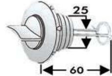
In nylon, con sicurezza per il tappo. Completo di boccolla per montaggio a pressione; Ø foro da praticare nello scafo: 25 mm. Colore: bianco.
