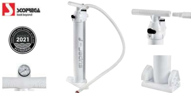
Il tubo di gonfiaggio in alluminio è posizionato all'esterno del corpo garantendo maggiore efficienza ed un minor sforzo. La posizione del manometro sul coperchio (non sull'impugnatura) facilita la lettura della pressione dell'aria. La base pieghevole e le maniglie smontabili consentono di risparmiare spazio nella confezione.
