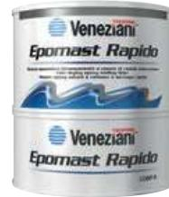
Stucco epossidico a rasare di rapida essicazione e per facile riparazione, con spessori fino a 10 mm per ogni passata. Può essere usato su qualsiasi supporto trattato con primer o direttamente su epomat-pro o su fondi epossidici.
