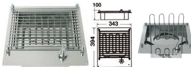
50.382.00 Totalmente in acciaio inox AISI 316, completo di raccogli sughii estraibile, resistenza elettrica basculante, griglia amovibile e fissata con speciali ganci anti-vibrazione, consumo 1500 W a 220 V.
